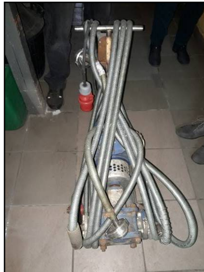
52. Pompa na kołach 1,1 kW lub 0,85 kW, wydajność 1200 l/h samoróbka
