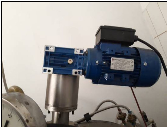
14. Pompa typ SK na wózku z silnikiem wydajność 1410 L
