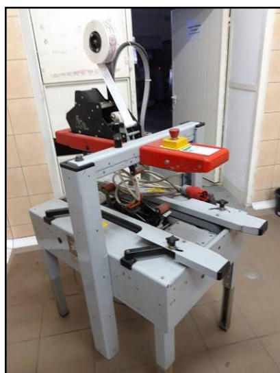
391. Zaklejarka do kartonów 3M –Metic wyremontowana przez Robak
