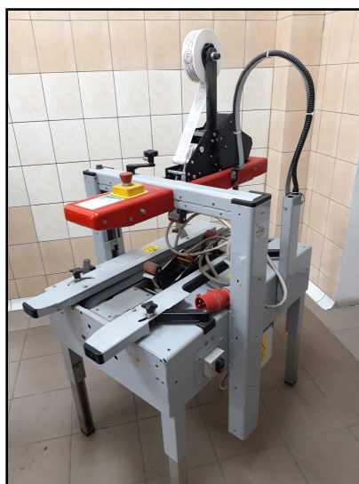
391. Zaklejarka do kartonów 3M –Metic wyremontowana przez Robak
