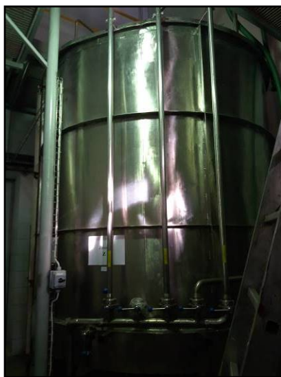
20. Zbiornik stalowy Z6 13.000 l kwasoodporny h-2,6 m , Fi 2,6 m
