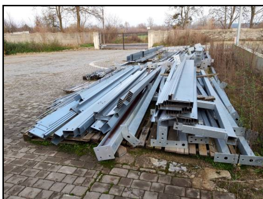
197. Elementy stalowe do budowy hali Dwuteownik 16 sztuk 11x22 długość 6 m Kątowniki 10x10 8 t Elementy stalowe 16x10x5,75 m 20 sztuk
