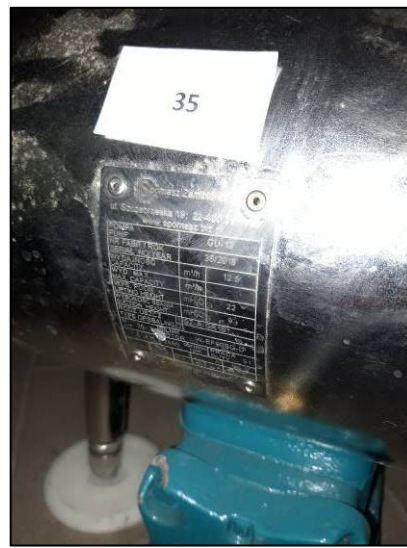
30. Pompa typ SK na wózku z silnikiem 1,1 kW SK na wózku z silnikiem
