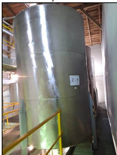
24. Zbiornik stalowy Z9 9.000 l. kwasoodporny h-3 m Fi 2 m
