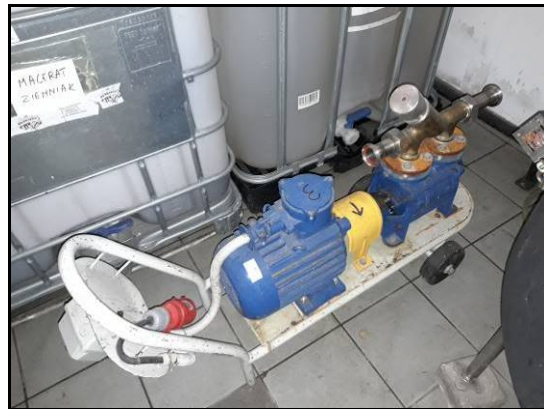
14. Pompa typ SK na wózku z silnikiem wydajność 1410 L
